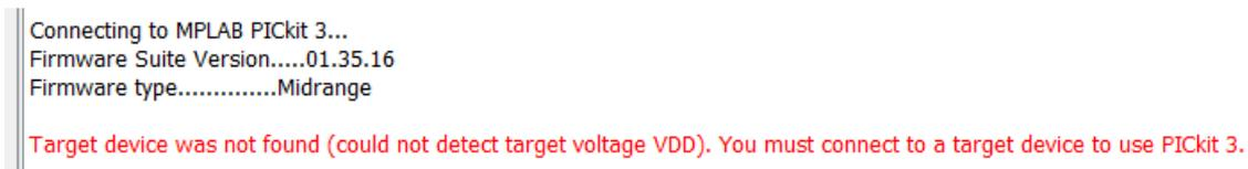
Damit PicKit3 die Spannungsversorgung macht, sonst muss dies mit „Power Target Circuit from Tool“ definiert werden!
